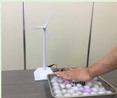
体温で発電して風車が回転
